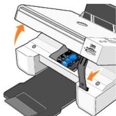
Il supporto delle cartucce di inchiostro viene spostato nella posizione di caricamento, a meno che la stampante non sia occupata.
